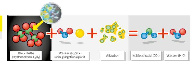
Der biologische Reinigungsprozess unter dem Mikroskop: Organische Substanzen werden durch den Einsatz von wasserbasiertem Reinigungsmittel und Mikroben auf biologische Weise zu Kohlendioxid und Wasser abgebaut.
