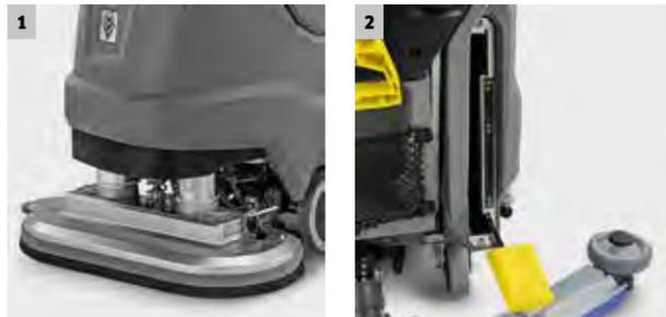
**1 Stark beanspruchte Teile wie Saugbalken und Bürstenkopf sind aus hochwertigem Aluminium gefertigt**
