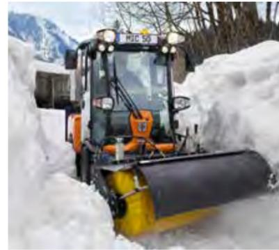
MIC 50, Frontkehrmaschine
